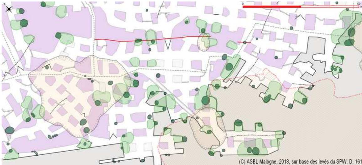
Carrières souterraines de la Malogne (Cuesmes). Densité des racines de poches karstiques visibles près de l’affleurement (taches vert sombre) et cônes d’éboulis sableux dans les galeries (taches vert clair, h=2 à 5 m). (ASBL Malogne, 2018 sur base des levés du SPW, Dir. de la Géotechnique)
